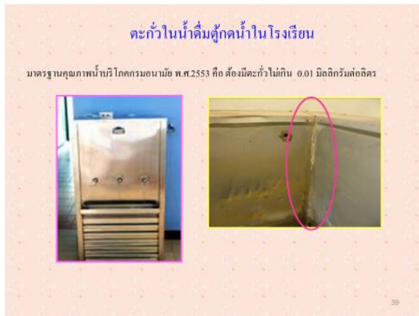
ตัวอย่าง การปนเปื้อนสารตะกั่วในน้ำดื่ม เนื่องจากมีการใช้ตะกั่วในการบัดกรีตู้กดน้ำดื่ม
