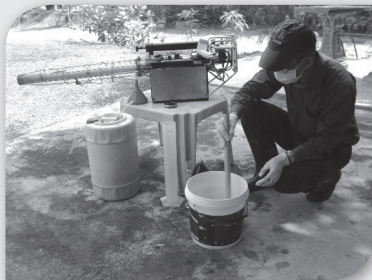
เตรียมสารเคมีอัตราผสมตามคำแนะนำตามฉลากสำหรับเครื่องพ่นหมอกควัน
