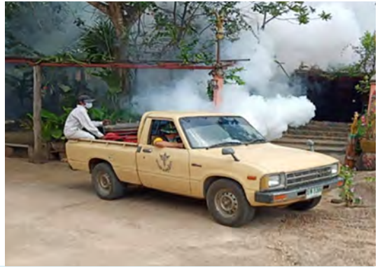
การพ่นสารเคมีด้วยเครื่องพ่นหมอกควันแบบติดตั้งบนรถยนต์ ที่มา : ศูนย์ควบคุมโรคติดต่อฯ โดยแมลงที่ 5.1 จังหวัดกาญจนบุรี
