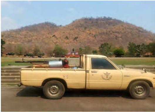
การพ่นสารเคมีด้วยเครื่องพ่นหมอกควันแบบติดตั้งบนรถยนต์ ที่มา : ศูนย์ควบคุมโรคติดต่อฯ โดยแมลงที่ 5.1 จังหวัดกาญจนบุรี
