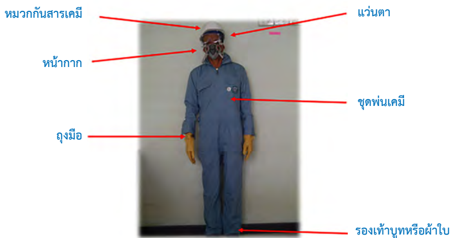
ภาพที่ 5.2 ชุดป้องกันในการพ่นสารเคมีชนิดตัดสำเร็จรูปพร้อมอุปกรณ์ป้องกัน (9)
