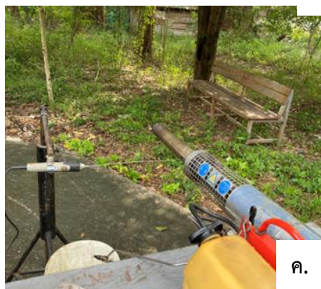
ภาพที่ 3.1 ขั้นตอนการวัดอุณหภูมิความร้อนปลายท่อ ณ หัวพ่นน้ำยาเคมี
