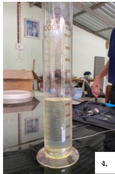
ภาพที่ 3.2 ขั้นตอนการประเมินอัตราการไหลของน้ำยาเคมี
