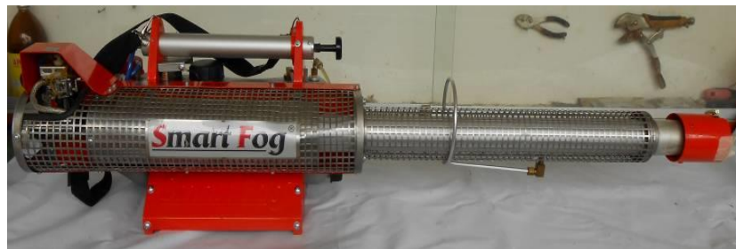
ภาพที่ 2.9 ลักษณะของเครื่องพ่นหมอกควันยี่ห้อ สมาร์ทฟอกซ์ (Smart fog)
