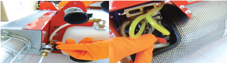
1. ปิดวาล์วสารเคมี
