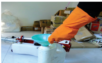
1. ตวงน้ำมันดีเซลโดยผ่านกรวยกรอง 5 ลิตร
