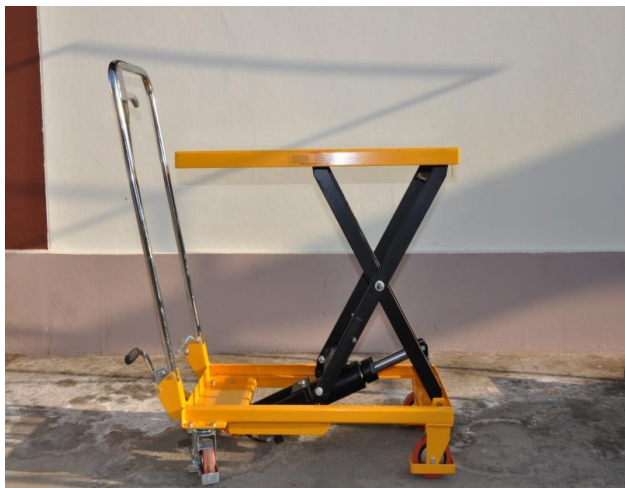
รูปที่ 10 ระบบยกตัวของคนใช้โดยใช้ระบบไฮดรอลิก
