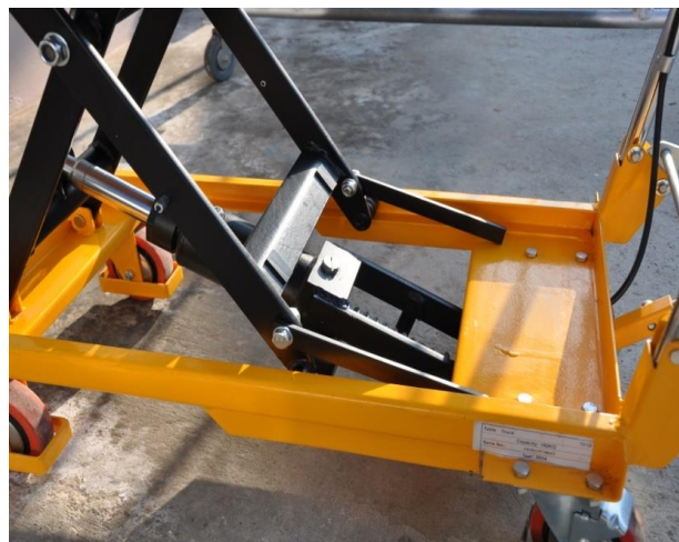
รูปที่ 10 ระบบยกตัวของคนใช้โดยใช้ระบบไฮดรอลิก
