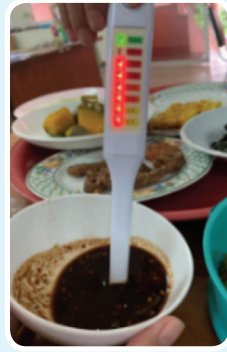
ภาพที่ 5 การตรวจวัดความเค็มในตัวอย่างอาหาร โดยใช้เครื่องวัดความเค็ม
