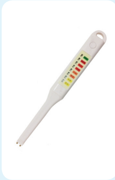
ภาพที่ 5 การตรวจวัดความเค็มในตัวอย่างอาหาร โดยใช้เครื่องวัดความเค็ม
