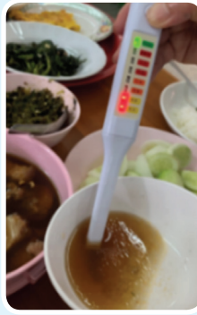
ภาพที่ 5 การตรวจวัดความเค็มในตัวอย่างอาหาร โดยใช้เครื่องวัดความเค็ม
