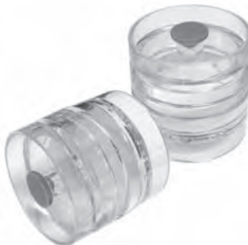
ภาพที่ 4-6 ตลับใส่ตัวกรองขนาด 37 มิลลิเมตร และตัวกรองชนิด MCE 0.8 ไมครอน
