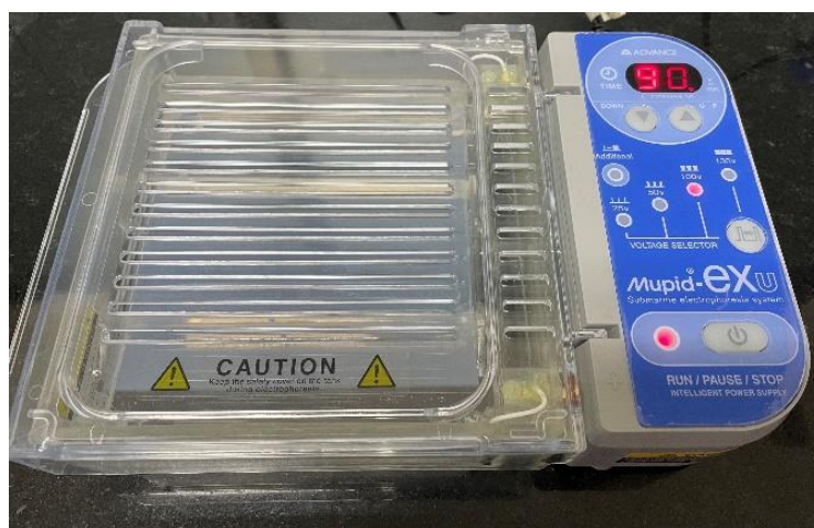
ภาพที่ 9 เครื่อง Run gel electrophoresis รุ่น Mupid-exU
