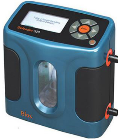
ภาพที่ 4.8 ตัวอย่างอุปกรณ์ชุดปรับเทียบมาตรฐาน (calibrator)
