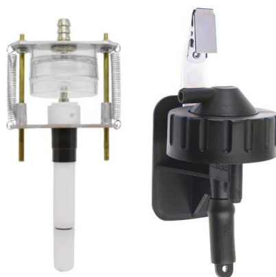
ภาพที่ 4.3 Nylon cyclone, Higgins-Dewell cyclone
