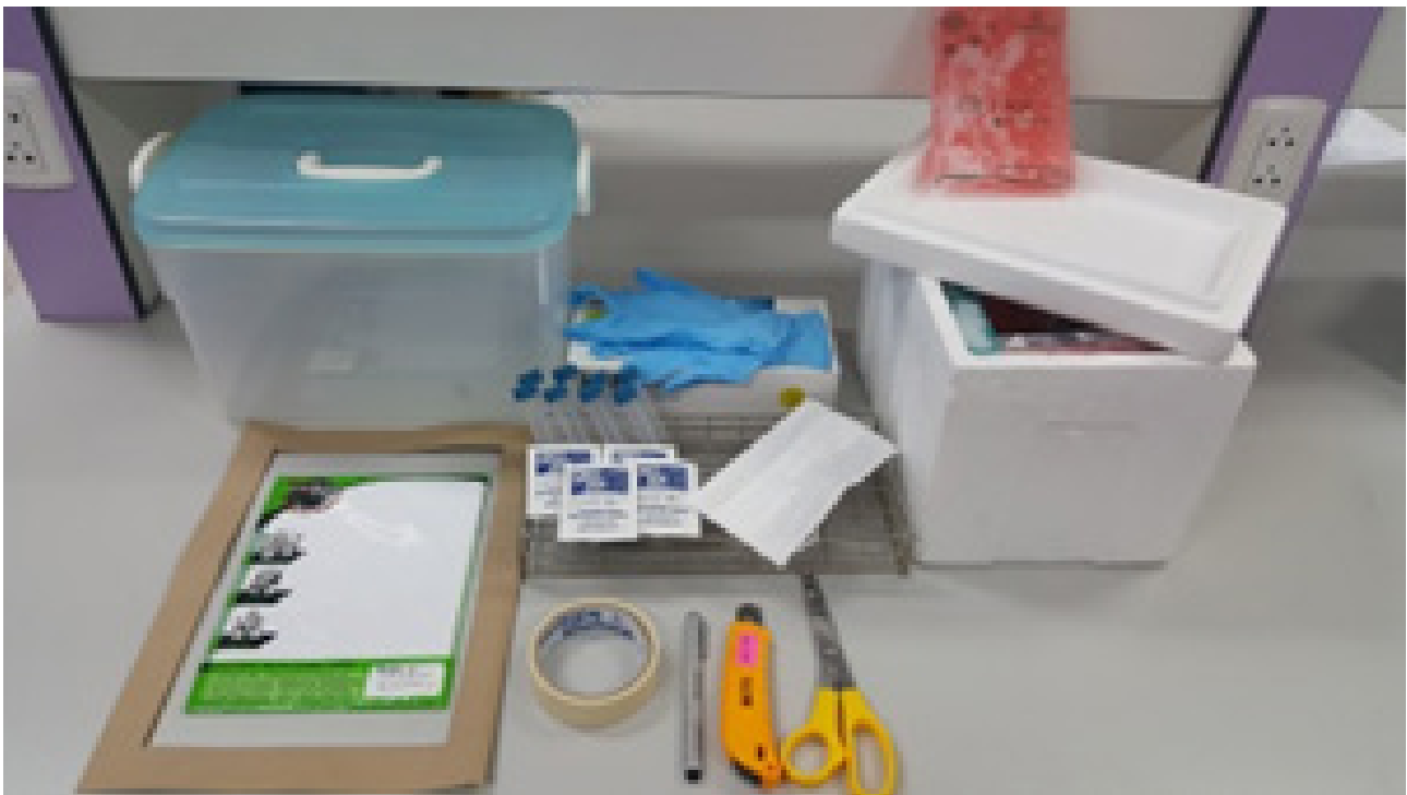
ภาพที่ 4.11 ชุดอุปกรณ์สำหรับการเก็บตัวอย่างฝุ่นตะกั่วบนพื้นผิว
